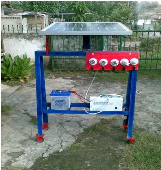
Gambar 8 : Pembangkit Listrik Tenaga Surya Skala Laboratorium
